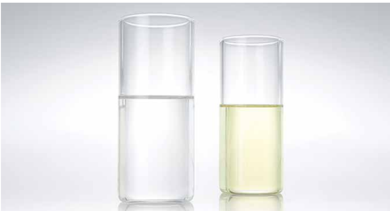
FARBVERGLEICH VON GTL (LINKS) UND DIESEL (RECHTS)
