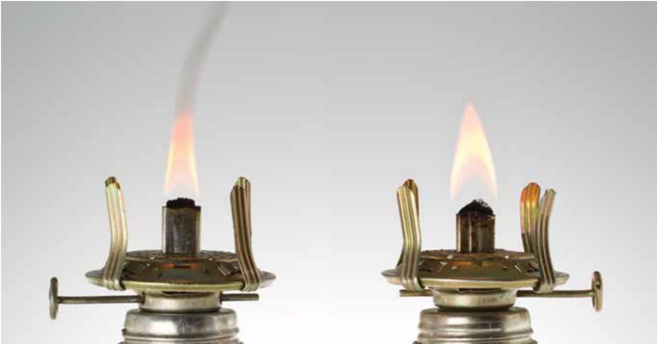
STANDARD DIESEL (LINKS) UND SHELL GTL FUEL (RECHTS)
